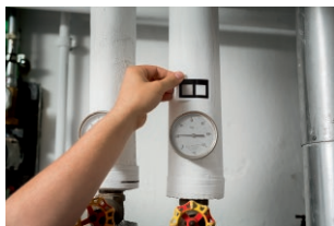
粘贴德图发射率标签
