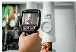
自动确定 \epsilon (发射率)和RTC (反射温度)
